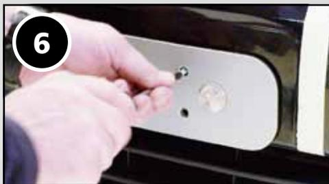
Befestigen der Grundplatte am Fahrzeug.
