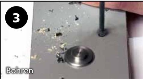
Bohren und sorgfältiges Senken der Grundplatte.
