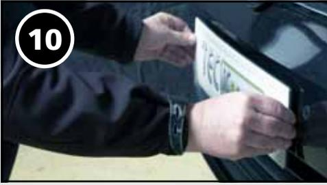
Zur Verbindung der Deckplatte mit dem aufgeklebten Kennzeichen und der auf dem Fahrzeug montierten Grundplatte ist die Deckplatte in entsprechender Position an die Grundplatte heranzuführen und sicherzustellen, dass **2x ein deutliches Einrasten der Magnetverbindung wahrgenommen wird.**
